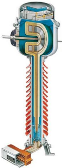
Fig. 1.6 T.I. Tipo núcleo superior
